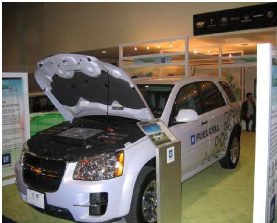
ნახ. 3.3. „მწვანე“ ავტომობილი, ელექტრომობილი საწვავ-ელემენტით, საწვავი - წყალბადი
